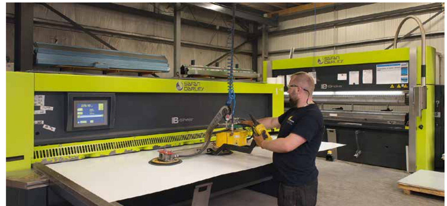
Met een zuignap wordt een zetwerkplaat opgetild. Van vlakke sendzimir platen (voorverzinkt staal) worden zetwerkstukken gemaakt om de sandwichpanelen aan de zijkanten, bovenkanten en deuropeningen strak af te werken.
